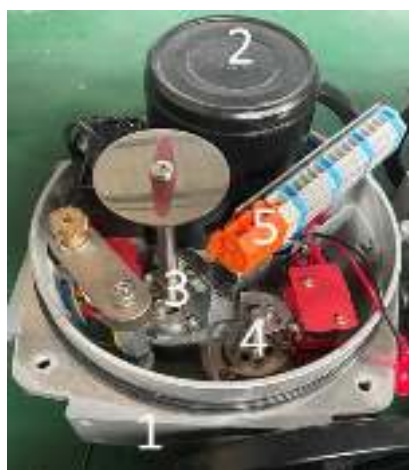
Рис. 2. Основные элементы конструкции электропривода.
